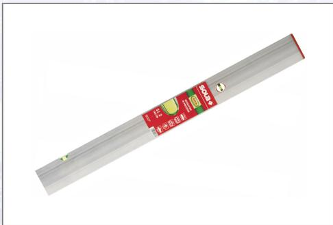
Alu-Rohrprofil mit Mittelsteg, mit 1 Waagrechtlibelle und 1 Senkrechtlibelle. Dimensionen ca. 100x18 mm, 870 g/lfm. Entgratetes Profil, daher keinerlei Verletzungsgefahr, bruchfeste Acrylglas-Blocklibellen und stoßdämpfende Endkappen. Maximale Messtoleranz in Standardposition 0,75 mm/m (0,043 ‰).
