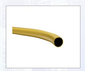
Sehr flexibler PVC-Wasserschlauch mit 10 bar Betriebsdruck, Platzdruck 30 bar. Temperaturbeständigkeit -15/+60 °C. Cadmiumfrei, keine Algenbildung, nicht toxisch, UV-stabil. Durch die innovative Konstruktion der Polyester-Armierung wird eine erhöhte Flexibilität und ein optimierter Verdrehschutz im Vergleich zu Wasserschläuchen mit gestrickter Armierung erreicht.
