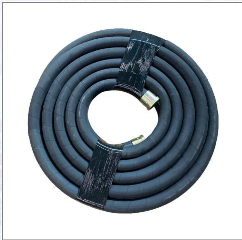
Torkret-Betonförderschlauch mit beidseitig eingebundenen Schlauchhülsen Vic. Entwickelt zur pneumatischen Förderung von abrasiven Materialien wie Zement, Sand, Kies, Zuschlagstoffen, etc. Temperaturbereich -35 °C bis +80 °C. Betriebsdruck 10 bar, Sicherheitsfaktor 3,15 :1, Schlauchlänge 20 m.
