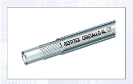
Glasklarer, flexibler Weich-PVC-Schlauch, glatt mit druckfester Polyestereinlage. Geeignet als Wasser- oder Druckluftschlauch. Geeignet für chemische, nicht besonders aggressive Flüssigkeiten. - Betriebsdruck 6 bar (18 °C) - Innen-Ø 38 mm / Wandstärke 5 mm - Umweltfreundliches Material in Lebensmittelqualität
