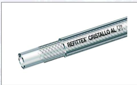
Glasklarer, flexibler Weich-PVC-Schlauch, glatt mit druckfester Polyesterereinlage. Geeignet als Wasser- oder Druckluftschlauch. Geeignet für chemische, nicht besonders aggressive Flüssigkeiten. - Betriebsdruck 6 bar (18 °C) - Innen-Ø 38 mm / Wandstärke 5 mm - Umweltfreundliches Material in Lebensmittelqualität
