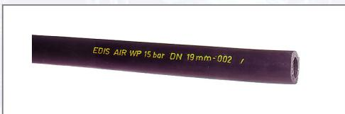
Universell einsetzbarer, leichter Pressluftschlauch mit hoher Flexibilität für Wasser und schmierstoffhaltige Pressluft. Mit Rayon Einlage. Decke SBR licht- und wetterbeständig. - Betriebsdruck 15 bar - Temperaturbereich -35 °C bis +80 °C.
