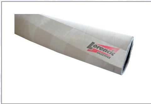
Spezialschlauch, geeignet zur Förderung von Estrich, Mörtel, Gips und Beton. Temperaturbereich -40 °C bis +70 °C. Schwarze, glatte, hochabriebfeste und antistatische SBR/NR-Seele, hochreißfeste Textileinlagen, verdeckt liegende Kupferlitze. Schlauchdecke aus hochabriebfestem, synthetischem, weißem Gummi, dadurch kein Abfärben an Wänden im Innen- oder Außenbereich. SBR/NR-Decke, stoffgemustert, antistatisch, ozon- und witterungsbeständig.
