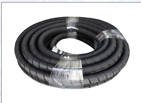
Hochabriefester Förderschlauch aus Gummi mit Textilcordeinlage für die Förderung von Gips, Kalk- und Zementemulsionen. Beidseitig eingebundene Storz-C/45-Saugkupplungen aus Aluminium mit Schellen aus Edelstahl DN 45, 10 bar. - Betriebsdruck des Schlauches: 10 bar, - Temperaturbereich: -30 °C bis +80 °C, - Innendurchmesser: 45 mm, - Wandstärke: 7 mm.
