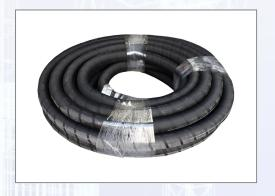
Hochabriefester Förderschlauch aus Gummi mit Textilcordeinlage für die Förderung von Gips, Kalk- und Zementemulsionen. Beidseitig eingebundene Storz-C/45-Saugkupplungen aus Aluminium mit Schellen aus Edelstahl DN 45, 10 bar. - Betriebsdruck des Schlauches: 10 bar, - Temperaturbereich: -30 °C bis +80 °C, - Innendurchmesser: 45 mm, - Wandstärke: 7 mm.
