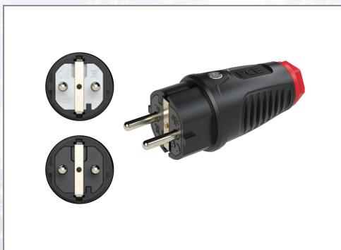
Steckermodule mit Schnapp-In Zugentlastung und Membrandichtung. Einfaches Montieren und Demontieren der Kontaktträger, großer Anschlussraum, leicht bedienbare Zugentlastungselemente (offene Schrauben). Im Steckerteil offene +/- Kontaktschrauben, ausgerichtet, Trichtereinführung der Leiter, offene Zugentlastung. Für erschwerete Bedingungen geeignet, 16 A 250 V, 3p (2P+E). Farbe: (Haube/Ring): schwarz/rot. IP 54 staub- und spritzwassergeschützt, nach österreichischer/deutscher Norm.
