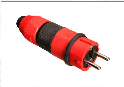
Äpfel und Öfen - fibrä Extrem robuster, belastbarer Schuko-Stecker mit doppeltem Erdungssystem, Knickschutztülle und Schnellverschluss nach deutscher und französischer Norm. Spritzwassergeschützt IP 54, 16 A, 230 V, nach DIN 49440/441, zum Anschluss von Leitungen bis 3x2,5 mm<sup>2</sup>. Schlagfest, griffig und rutschfest aufgrund Zwei-Komponenten-Technologie. UV- und medienbeständig, hitzebeständig bis 80 °C, kältebeständig bis -40 °C.
