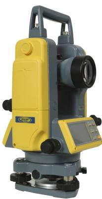
Umfangreich ausgestatteter elektronischer Digital-Theodolit für Winkelmessungen. Der SPECTRA PRECISION ® DET-2 ist ein robuster und kostensparender Theodolit für genaue Winkelmessungen in allgemeinen Bauanwendungen. Er besitzt auf beiden Instrumentenseiten ein großes LCD-Display mit großen, gut lesbaren Zeichen. Die integrierte Fadenkreuz- und LCD-Beleuchtung kann bei Bedarf in ungünstigen Lichtverhältnissen mit einem einfachen Tastendruck aktiviert werden. Anwendungen:
