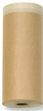
Zum Abkleben und Schützen von glatten und leicht rauen Untergründen im Innenbereich. Bis 7 Tage einsetzbar und rückstandsfrei entfernbar. Für kleinere Flächen wie Fuß- und Sockelleisten, Türrahmen usw. Spezifikation Kreppband: - Dicke: ca. 0,13 mm, - Kleber: Naturkautschuk, - Klebekraft: ca. 6 N/25 mm, - Hitzebeständigkeit: 60 °C kurzfristig. Spezifikation Papier: Material: - Natron-Kraftpapier, - Gewicht: 35 gr/m<sup>2</sup>. !Keine Haftung für Rückstände!
