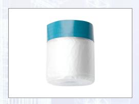
Zum Abkleben und Schützen von rauen und schwierigen Untergründen wie Stein, Putz, Mauerwerk usw. Für den Innenund Außenbereich einsetzbar, im Außen bis 21 Tage. Nicht für empfindliche Untergründe geeignet. Spezifikation Gewebeband: - Dicke: ca. 0,30 mm, - Kleber: Naturkautschuk, - Klebkraft: 9 N/25 mm, - Temperaturbeständigkeit: 50 °C. Spezifikation Folie: - Material: HDPE Abdeckfolie, - Stärke: 0,015 mm, extra dicke Folie. Hohe Statik, sehr anschmiegsam. !Keine Haftung für Rückstände!
