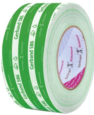
Sehr schmiegsames und dehnfähiges PE-Folien-Abdichtungs-Klebeband mit einem Polyacrylatkleber von extrem hoher Klebkraft und sehr guter Alterungsbeständigkeit. UV-stabilisiert, mit PET-Fadengelege verstärkt. Zum luftdichten Verkleben und Abdichten bei Durchdringen und Überlappungen, Anschlüssen und bei Durchdringungen von Dampfbremsfolien. - Dicke: 0,34 mm, - Reißkraft:  $\geq 50$  N/25 mm, - Dehnung: 20 %, - Klebkraft:  $>30$  N/25 mm, - Temperaturbereich: von -40 °C bis +80 °C.
