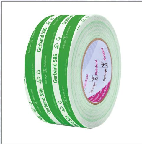
Sehr schmiegsames und dehnfähiges PE-Folien-Abdichtungs-Klebeband mit einem Polyacrylatkleber von extrem hoher Klebkraft und sehr guter Alterungsbeständigkeit. UV-stabilisiert, mit PET-Fadengelege verstärkt. Zum luftdichten Verkleben und Abdichten bei Durchdringen und Überlappungen, Anschlüssen und bei Durchdringungen von Dampfbremsfolien. - Dicke: 0,34 mm, - Reißkraft:  $\geq 50$  N/25 mm, - Dehnung: 20 %, - Klebkraft:  $>30$  N/25 mm, - Temperaturbereich: von -40 °C bis +80 °C.
