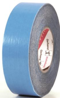
Beidseitig klebender, anwendungsfertiger Polyacrylat-Haftklebefilm auf Rolle. Dient zum luftdichten Verkleben von Überlappungen und Durchdringungen von Dampfbremsfolien sowie zum selbstklebenden Ausrüsten und Kaschieren von bahnförmigen Materialien. - Träger: Polyester-Fadengelege, - Klebstoff: Polyacrylat-Haftkleber, Klebekraft: >25 N/25 mm, - Temperaturbereich: von -30 °C bis +100 °C (kurzzeitig bis +120 °C).
