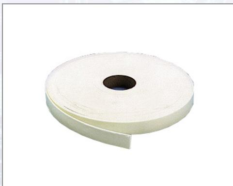
Schaumstoffband aus geschlossenzelligem Polyethylenschaumstoff, mit selbstklebendem Klebebandstreifen im Randbereich. Das 3 mm starke Band schafft eine Dehnfuge und schützt angrenzende Bauteile vor Verschmutzung. Temperaturbeständig von -40 °C bis +80 °C. - Klebstoff: Acrylat-Dispersion (lösemittelfrei) - Klebstoffzwischenträger: Polyesterfolie.
