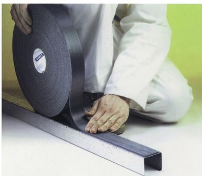
Einseitig selbstklebendes Dichtungsband für die akustische Abdichtung im Trockenbau, gem. DIN 4102 Teil 1 (Baustoffklasse B1). Material ist physikalisch vernetzter Polyethylenschaum, anthrazit mit 3 mm Stärke. Klebstoff Hot-Melt auf Kautschukbasis. Temperaturbeständigkeit: von -30 °C bis +80 °C.
