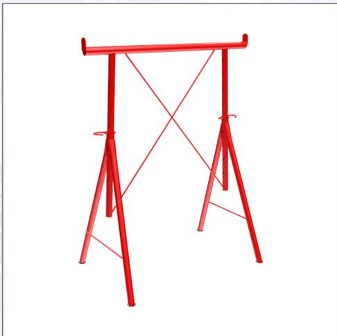
Der meistgekaufte in Österreich! Seitliche Laschen am Auflagerrohr verhindern ein Abrutschen des Belages. Der Vorstecker im Schrägschlitz gewährleistet unter Belastung beste Standfestigkeit. Mit Fußplatten für einen sicheren Stand auch auf weichem Untergrund. - Auflagebreite 120 cm, - alle 10 cm höhenverstellbar, - max. zulässige Belastung 6 kN bei gleichmäßiger Belastung über die gesamte Breite, - zusammenlegbar.
