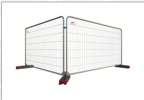
Mobilzaunelement mit geschlossenem Rohr. Dadurch entfallen die Schweißnähte an den beiden obenliegenden Eckverbindungen. Mit Haken und Öse. Technische Daten: - Maschenweite: 100x262 mm, - Drahtstärke: horizontal 3,2 mm, vertikal 3,2 mm, - Rohrdurchmesser: 38,1 mm, - Gewicht: 15,4 kg.
