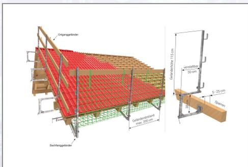
Zur seitlichen Absicherung der Dachfläche, zertifiziert nach EN 13374 Klasse A. Verschiebbare Ausführung damit das Geländer immer direkt an der Dachkante steht. Sichere Klemmung auf dem Sparren am Dachende. Stabile feuerverzinkte Ausführung für Ihre Sicherheit. Auch zum Einlegen von Holzbrettern geeignet. Geländerhöhe: 115 cm.
