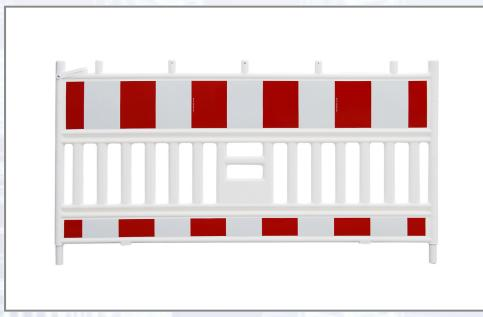
Die Absturzsicherung ist mit 2 Standrohren 42 mm ausgestattet. Kein Verbiegen oder Brechen auch bei extremer Beanspruchung oder Gewalteinwirkung. Praktischer, mittig angeordneter Griff für leichtes Handling. Entspricht den TL für Absperrschränken und den Vorschriften der ZTV-SA. Beschriftungsfeld 230x100 mm für Ihr Kundenlogo. Folie Reflexionsklasse RA 1, Gewicht 15,5 kg.
