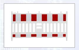
Die Absturzsicherung ist mit 2 Standrohren 42 mm ausgestattet. Kein Verbiegen oder Brechen auch bei extremer Beanspruchung oder Gewalteinwirkung. Praktischer, mittig angeordneter Griff für leichtes Handling. Entspricht den TL für Absperrschranken und den Vorschriften der ZTV-SA. Beschriftungsfeld 230x100 mm für Ihr Kundenlogo. Folie Reflexionsklasse RA 1, Gewicht 15,5 kg.
