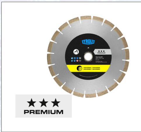
Diamant-Nassschnittsägeblätter für Tischsägen sind universell einsetzbar für Waschbeton, Betonstein, Kalkstein hart, Ziegel weich etc. Bei allen Tischsägeblättern sind Reduzierringe von 35 auf 30 mm bzw. 25,4 mm beigelegt. Ab Durchmesser 625 mm werden Reduzierringe von 60 auf 55 mm mitgeliefert. Geräuschgedämpftes Stammbrett in Sandwichbauweise.
