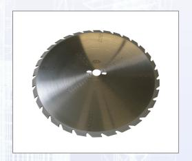
Das Hartmetall-Sägeblatt, nagelfest und schallgedämpft, für Baukreissägen - zur Verwendung von groben Brenn- und Bauholzschnitten. Unempfindlich gegen Betonreste und bedingt nagelsicher (nicht geeignet für Stahlnägel etc.). Das Stammblatt hat eine Stahlgüte von C75. Bohrung 30 mm.
