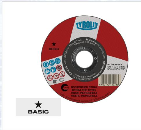
Die BASIC Trennscheibe für Edelstahl verwenden Sie zum Trennen von Blechen, Profilen, Rohren, Stäben mit kleinen Durchmessern und Vollmaterial. Die chemische Reinheit dieser Werkzeuge ist für die Bearbeitung von rostfreien Stahlsorten Voraussetzung, um negative Werkstoffbeeinflussung wie Korrosionsbildung, Lochfraß oder Reduktion der Dauerfestigkeit zu vermeiden. Die 1,0 mm starken Trennscheiben sind besonders für schnelles, komfortables und grätfarmes Trennen geeignet.
