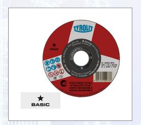
Die BASIC Trennscheibe für Edelstahl verwenden Sie zum Trennen von Blechen, Profilen, Rohren, Stäben mit kleinen Durchmessern und Vollmaterial. Die chemische Reinheit dieser Werkzeuge ist für die Bearbeitung von rostfreien Stahlsorten Voraussetzung, um negative Werkstoffbeeinflussung wie Korrosionsbildung, Lochfraß oder Reduktion der Dauerfestigkeit zu vermeiden. Die 1,0 mm starken Trennscheiben sind besonders für schnelles, komfortables und gratarmes Trennen geeignet.
