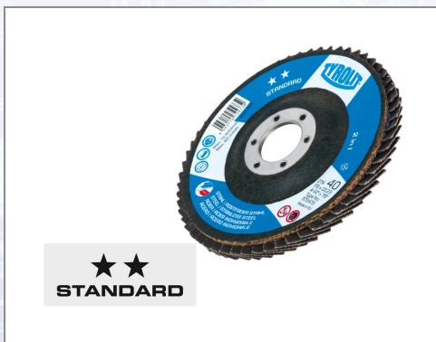
Lameller für sämtliche Metalle, auch NE-Metalle, Kunststoffe, Holz, Lacke und Spachtelmasse mit reduzierter Drehzahl bearbeitbar. 27XLA Tragsteller aus Glasfasergewebe, extrem geräuscharm, Vs = 80 m/sec. Körnung: 40
