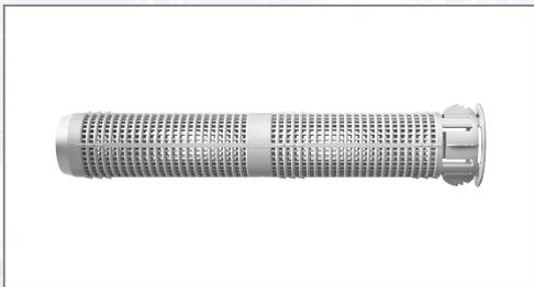
Für eine kontrollierte Montage im Lochbaustoff wird eine Siebhülse verwendet. Die Montage der Siebhülse erfolgt bündig mit dem Baustoff, die Siebhülse wird vollständig mit Injektionsmörtel aufgefüllt. Anschließend wird eine Gewindestange (RG-M) in die Siebhülse gesteckt, der Mörtel wird durch die Gitterstruktur der Ankerhülse gedrückt und passt sich dem Verankerungsgrund optimal an (Formschluss).
