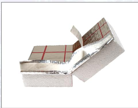
Die Rolldämmplatte ist eine verlegefertige Wärme- und Trittschalldämmung aus güteüberwachtem EPS-T gem. EN 13163 und einer aufkaschierten Alu-PET Gewebefolie für Fußboden/Flächenheizungen. Ein Ausreißen der Klipse ist durch das verstärkte Gewebe nicht möglich. Die Folie hat ein Raster von 50 mm aufgedruckt, welches ein einfaches und schnelles Montieren der Heizrohre ermöglicht. Die selbstklebende Überlappung beträgt 30 mm.
