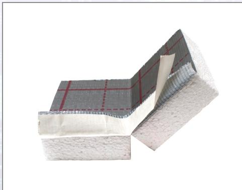
Die Rolldämmplatte ist eine verlegefertige Wärme- und Trittschalldämmung aus güteüberwachtem EPS-T gem. EN 13163 und einer aufkaschierten, hochreißfesten Gewebefolie für Fußboden/Flächenheizungen. Ein Ausreißen der Klipse ist durch das verstärkte Gewebe nicht möglich. Die Folie hat ein Raster von 50 mm aufgedruckt, welches ein einfaches und schnelles Montieren der Heizrohre ermöglicht. Die selbstklebende Überlappung beträgt 30 mm.
