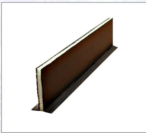
Zur Ausbildung dauerelastischer Fugen und zur sicheren Begrenzung von Estrichfeldern. Dieses Dehnfugenprofil ermöglicht die Ausbildung von geraden Fugen auch in großen Räumen. Es nimmt keine Feuchtigkeit auf und hat einen elastischen Polyethylenkern. Durch die Selbstklebefolie am Fuß ist es leicht, es an der Trennfolie unter dem Estrich zu fixieren.
