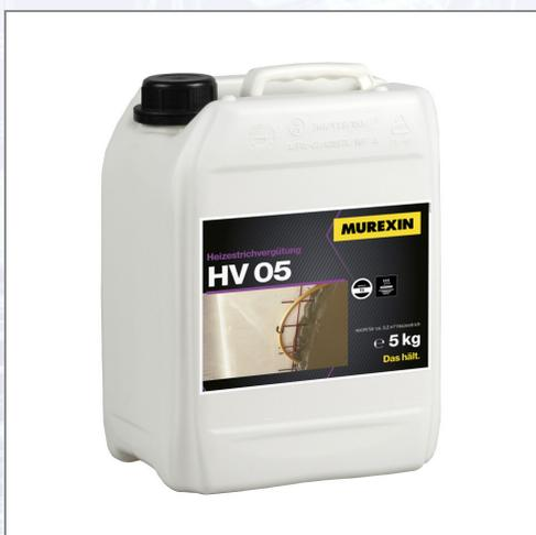
Äpfel und Öfen - fibrä Flüssiges, chloridfreies, verflüssigend wirkendes Zusatzmittel für zementgebundene Heizestriche. Zur Estrichvergütung bei Fußbodenheizung ohne Luftporeneinführung sowie zur Plastifizierung und damit verbundener leichter Verarbeitung. Verbessert die Heizrohrummantelung. Nur im Innenbereich anwenden. Verbrauch: 0,5 % vom Zementgewicht (ca. 2 kg/m<sup>3</sup> Beton).
