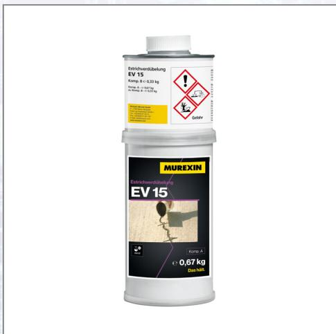
2-Komponentiges, lösemittelfreies, lebensmittelechtes, verseifungsbeständiges, schwundfreies und dünnflüssiges Reaktionsharz auf Epoxybasis. Das Material härtet auch in dicken Schichten aus und bildet eine kraftschlüssige und dichte Verbindung mit dem Untergrund. Im Innen- und Außenbereich, zum Ausgießen und Verfüllen von engen und tiefen Rissen, Löchern und Hohlräumen. Verbrauch: ca. 1,1 kg/l Füllraum.
