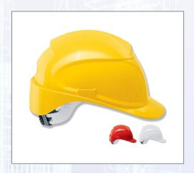
leichter Schutzhelm Neuer mit variablen Ventilationsöffnungen, eine im Stirnsowie zwei im Hinterkopfbereich. Ausgestattet mit Schweißband. - 6-Punkt-Textilbandaufhängung gewährleistet optimale Passform und Komfort, - seitliche Euroslot-Aufnahmen (30 mm) für die Montage von Gehörschutzkapseln oder Visieren, Drehradsystem für eine stufenlose Weitenregulierung, - Norm EN 397: Zusatzanforderungen für sehr niedrige Temperaturen (-30 °C), - Einstellbereich: 52-61 cm, - Gewicht: 440 g.
