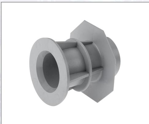
Vorsatzkonus für die Selbsterstellung von wasserdichten Schalungsspannstellen. Durch Ablängen eines Kunststoffrohres 22/26 mm um 8 cm kürzer als die gewünschte Wandstärke und Aufpressen eines OKTAGON Konus, können Sonderlängen mit den Eigenschaften von OKTAGON hergestellt werden.
