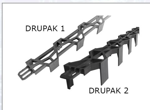
Großflächiger und besonders stabiler Abstandhalter, vorwiegend für die untere Bewehrung. Hergestellt aus 100 % recyceltem, PVC-freiem Kunststoff. Besonders guter Betondurchfluss durch große, seitliche und obenliegende Aussparungen. Für Sichtbeton und Elementdecken nur bedingt geeignet. DRUPAK 1: Breite 36 mm. Aufgrund besserer Kippstabilität empfehlen wir ab Betondeckung 40 mm DRUPAK 2 (Breite 46 mm).
