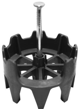
Durch die offene Formgebung kann dieser Schalungsanschlag sehr gut von Beton durchflossen werden. Schnelles Anbringen durch Bolzensetzgeräte bei Verwendung des Schalungsanschlages mit vormontiertem Nagel. PVC-frei.
