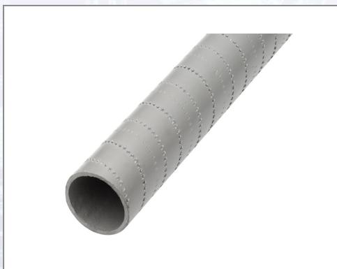
Als Mauerstärken - Abstandhalter für die senkrechte Schalung. Durch die gerillte Oberfläche haben die Rohre im Beton einen besseren Halt. Die benötigten Längen können schnell durch Ablängen des Abstandrohres vor Ort hergestellt werden. Material: PVC, frei von FCKW, HFKW, ohne besonders besorgniserregende Stoffe gemäß REACH-Verordnung.
