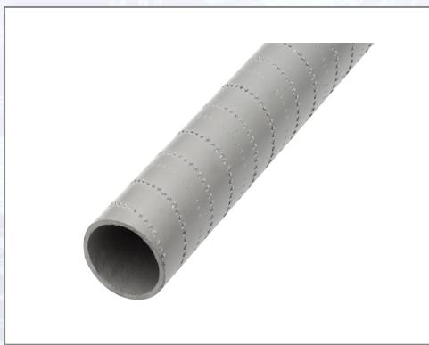
Als Mauerstärken - Abstandhalter für die senkrechte Schalung. Durch die gerillte Oberfläche haben die Rohre im Beton einen besseren Halt. Die benötigten Längen können schnell durch Ablängen des Abstandrohrs vor Ort hergestellt werden. Material: PVC, frei von FCKW, HFKW, ohne besonders besorgniserregende Stoffe gemäß REACH-Verordnung.
