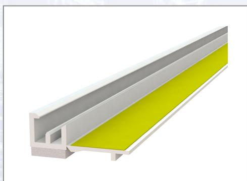
Äpfel und Öfen - fibră Die selbstklebenden Kunststoffprofile sind mit einem schlagregen- und luftundurchlässigen Dichtungsband, Stärke 2 mm, sowie mit einem Abknicksteg mit Selbstklebeband zur Aufnahme einer Schutzfolie für Fenster und Türen ausgestattet. Mindestverarbeitungstemperatur +5 °C. Maximale Profillänge 240 cm.
