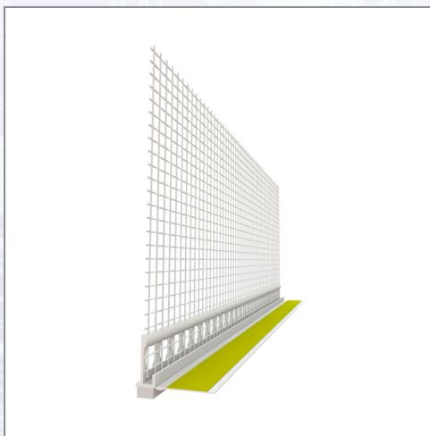
Laibungsanschlussprofil 6 mm mit Gewebe. Sauberer Anschluss, einfache Verarbeitung, keine nachträglichen Reinigungsarbeiten am Fenster- und Türrahmen. Mindestverarbeitungstemperatur +5 °C. Maximale Profillänge 240 mm. Gemäß Anwendungstabelle der Fenster- und Türanschlussprofile unter Zugrundelegung der aktuellen Verarbeitungsrichtlinien. Schlagregendicht nach DIN EN 1027, PE-Dichtband 3 mm, Klassifizierung nach ÖAP-Richtlinie Klasse I B. Gewebeteil 12 cm, Maschenweite 4x4 mm.
