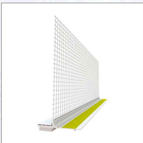
Das Profil ist ausgestattet mit einem Armierungsgewebe sowie einem schlagregen- und luftundurchlässigen Dichtungsband. Mit Gewebe. Mindestverarbeitungstemperatur +5 °C. Maximale Profillänge 240 mm. Gemäß Anwendungstabelle der Fenster- und Türanschlussprofile unter Zugrundelegung der aktuellen Verarbeitungsrichtlinien. PE-Dichtband 3 mm, Klassifizierung nach ÖAP-Richtlinie Klasse I B.
