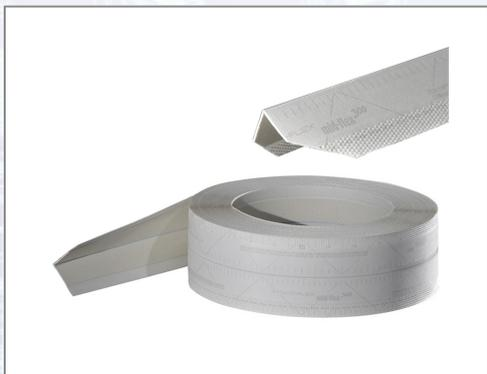
Flexibles, papierkaschiertes Kantenprofil für Innen- und Außenkanten im Trockenbau. Das Profil von der Rolle wird durch Falten an der rückstellfreien SUPERFLEX-Gelenkschiene in die gewünschte Winkelstellung gebracht. Die Rollenware in handlicher Verpackung ermöglicht ein individuelles Anpassen des Profils auf die Kantenlänge und reduziert dadurch Verschnitt und Kosten.
