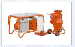
Funktionsbeschreibung: Die PFT SILOMAT TRANS PLUS fördert vollautomatisch und staubfrei Trockenmörtel zur Mischpumpe oder zum Durchlaufmischer. Die PFT SILOMAT TRANS PLUS vereint Design und Leistungsfähigkeit. Die Handhabung und der Transport der SILOMAT-Anlage wurden durch viele Helfer vereinfacht, wie zB die integrierten Krantransportösen und ausklappbaren Tragegriffe. Mit ein paar Handgriffen passt das PFT SILOMAT Fördergefäß an jeden Container/Silo. Die PFT
