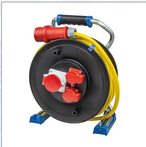
CEE-Kabeltrommel mit stabilem, stoßdämpfendem X-Doppelrohrgestell mit Sterngriffbremse. Mit ergonomischem, rutschfestem 2-Komponentengriff und patentierter Leitungsführung. 25 m Panzerleitung K35 AT-N07V3V3-F 5G2,5 gelb. CEE-Stecker 400 V/16 A/5-polig, 1 CEE-Steckdose 400 V/16 A/5-polig, 2 Einbausteckdosen 230 V/16 A mit Klappdeckel. 400 V / 16 A / max. 3x 3500 W. Trommel: d= 320 mm, Gewicht: 6 kg.
