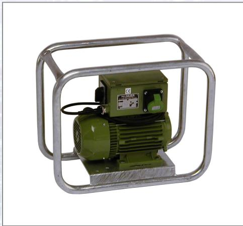
In Permanentmagnet-Ausführung. Umrichtung von 230 V auf 42 V. Speziell für die Anwendung von Rüttlern. Robuste Bauweise und geringe Reparaturanfälligkeit. Schutzart IP 44. Zum Anschluss von 2 Rüttlern bis LATI 57. Technische Daten: - Abgabe: 42 V / 27,5 A / 200 Hz, - Primärspannung: 400 V, - Leistungsaufnahme: 2,4 kVA / 10,5 A, - Gewicht: 27 kg.
