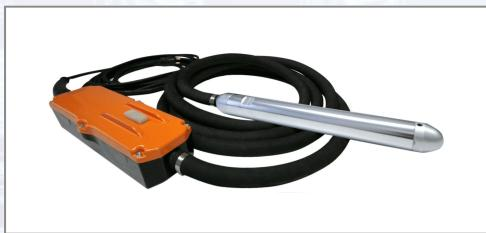
Die elektrischen Hochfrequenz-Innenrüttler Typ EWO zeichnen sich durch einen im Handschalter (IP 66) integrierten, handlichen, elektronischen Frequenzumrichter aus, der zum direkten Anschluss an jede Einphasen-Netzsteckdose geeignet ist. Diese Produktlinie zeichnet sich durch hohe Fliehkraft, konstante Geschwindigkeit und hohe Verschleißfestigkeit aus.
