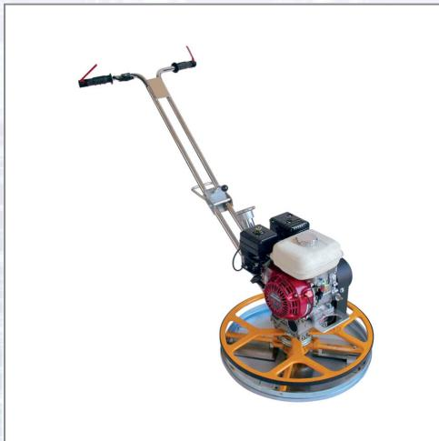
Flügelglätter mit Stabilisierungsring und klappbarem Führungsarm. Speziell konzipiert für Arbeiten in Ecken. Manueller Starter. Technische Daten: Durchmesser: 600 mm, HONDA Benzinmotor: 5,5 PS, Gewicht: 49 kg. Lieferumfang: 1 Glattscheibe d= 600 mm (Art. Nr. Z004105), 4 Finish- Blätter (Art. Nr. Z004200).
