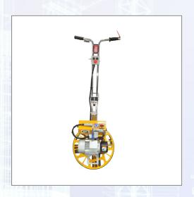
Flügelglätter mit Stabilisierungsring, Riemenscheibe und klappbarem Führungsarm. Speziell konzipiert für Arbeiten in Ecken. Technische Daten: - Durchmesser: 600 mm, - Elektromotor: 220 V/50 Hz, 3 PS mit Variator (Drehzahlregulierung), - Gewicht: 57 kg. Lieferumfang: 1 Glättscheibe d= 600 mm (Art. Nr. Z004105), 4 Finish- Blätter (Art. Nr. Z004200).
