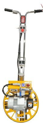
Flügelglätter mit Stabilisierungsring, Riemscheibe und klappbarem Führungsarm. Speziell konzipiert für Arbeiten in Ecken. Technische Daten: - Durchmesser: 600 mm, - Elektromotor: 220 V/50 Hz, 3 PS mit Variator (Drehzahlregulierung), - Gewicht: 57 kg. Lieferumfang: 1 Glattscheibe d= 600 mm (Art. Nr. Z004105), 4 Finish- Blätter (Art. Nr. Z004200).
