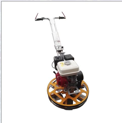
Flügelglätter mit Stabilisierungsring und klappbarem Führungsarm. Speziell konzipiert für das Arbeiten in Ecken. Die 6 Glättflügel gewähren ein schnelles und effizientes Glätten von Beton. Technische Daten: Durchmesser: 600 mm, HONDA Benzinmotor GX160 5,5 PS, Gewicht: 51 kg. Lieferumfang: 1 Glattscheibe d= 600 mm (Art. Nr. Z004110), 6 Finish- Blätter (Art. Nr. Z004205-1).
