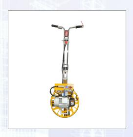
Flügelglätter mit Stabilisierungsring, Riemenscheibe und klappbarem Führungsarm. Speziell konzipiert für Arbeiten in Ecken. Die 6 Glättflügel gewähren ein schnelles und effizientes Glätten von Beton. Technische Daten: - Durchmesser: 600 mm, - Elektromotor: 220 V/50 Hz, 3 PS mit Variator (Drehzahlregulierung), - Gewicht: 59 kg. Lieferumfang: 1 Glättscheibe d= 600 mm (Art. Nr. Z004110), 6 Finish- Blätter (Art. Nr. Z004205-1).
