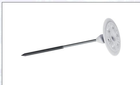
Schraubbefestiger für Fassadendämmplatten (EPS u. Mineralwolle) auf Holzuntergründen und Metallblechen bis Blechstärke 0,75 mm. Für die oberflächenbündige und oberflächennahe (vertiefte) Montage geeignet. Die vertiefte Montage erfolgt mit dem Montagewerkzeug ejotherm® STR-Tool 2GE und der dazu passenden STR-Rondelle. Bei oberflächenbündiger Montage wird die Schraubkopfvertiefung mit den in der Packung enthaltenen EPS-Stopfen verschlossen.
