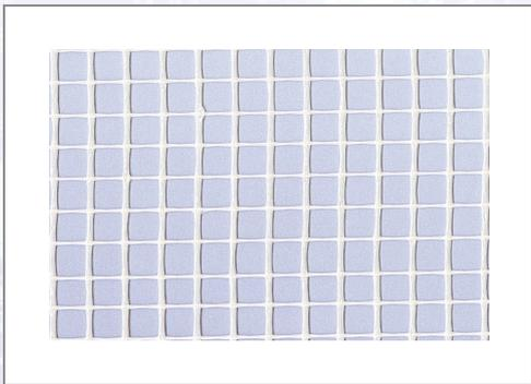
Äpfel und Öfen - fibră Das preiswerte Gewebe für den Innenputz, alkalibeständig und schiebefest ausgerüstet. Maschenweite 4,8x5,1 mm, Gewicht ca. 70 g/m<sup>2</sup>.
