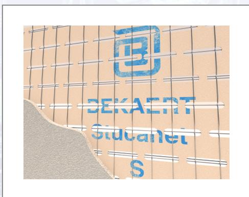
Äpfel und Öfen - fibră Stucanet ist ein Putzträger in Tafelform aus verzinkten, punktgeschweißten Drähten mit eingelegter Absorptionspappe. Der Anwendungsbereich ist die moderne Nassputztechnik im Innenbereich und an Fassaden. Der Putzauftrag erfolgt durch Aufspritzen mit Putzmaschinen oder durch Aufziehen per Hand.
